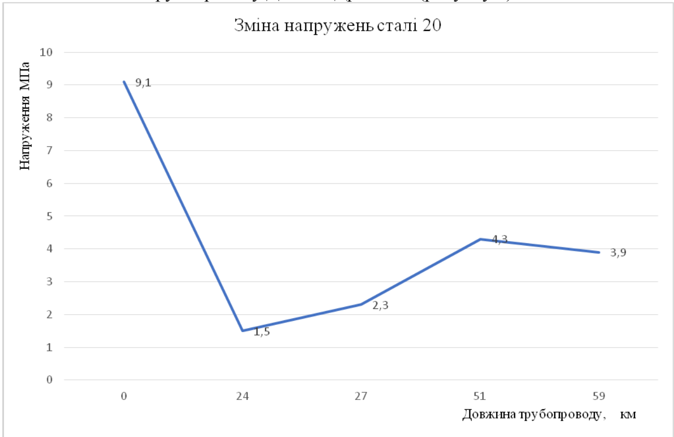
Рисунок 3- Зміна напружень по довжині трубопроводу Долина-Дрогобич
