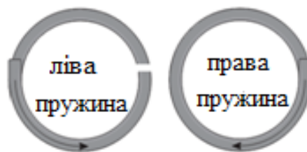
Рисунок 2- Напрямки навивки пружин і обертання вала
