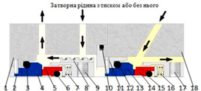
1-кришка; 2, 11-штифти; 3, 6, 12, 15-вторинні ущільнення; 4, 13-нерухомі кільця торцевих ущільнень; 5, 12-обертові кільця; 7, 16-блок пружин; 8-імпеллер; 9, 17-гвинти стопорні; 10-корпусне ущільнення 18-корпус ущільнення Рисунок 8- Торцеве ущільнення типу «Тандем»
