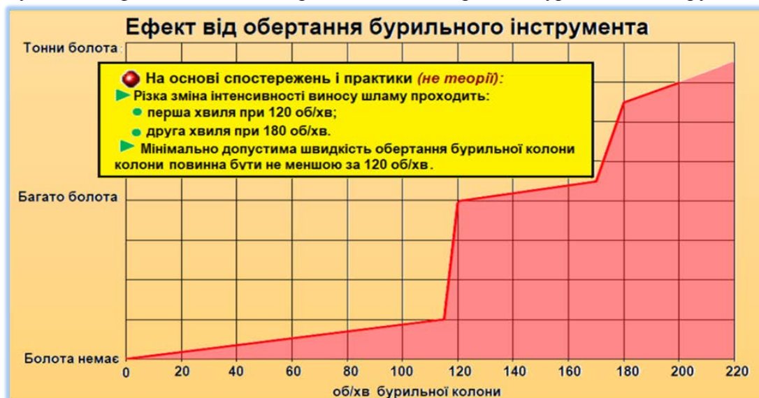
Рисунок 5 – Ефект очищення свердловини від обертання бурильного інструмента
