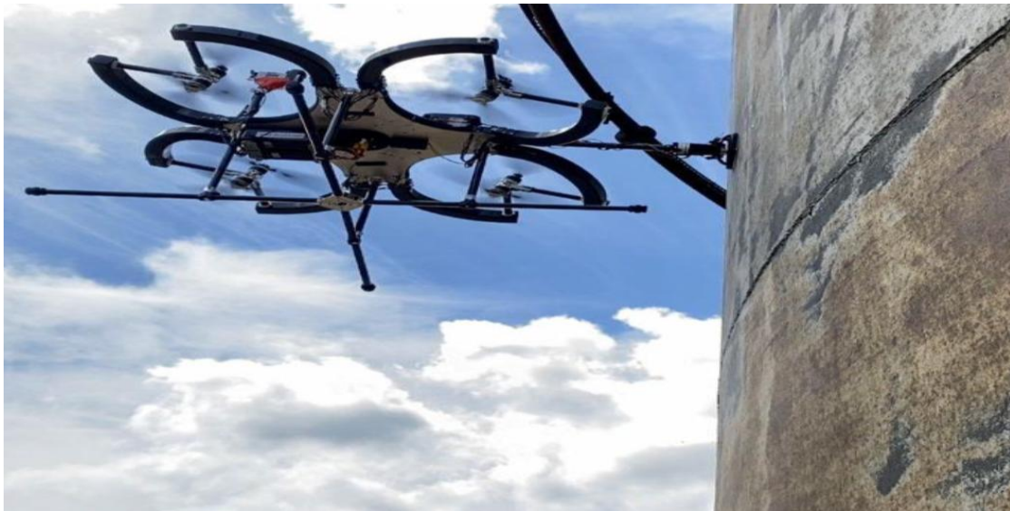
Рисунок 4.- Діагностування товщинометрії стінок резервуара для зберігання нафти і нафтопродуктів за допомогою безпілотних літальних апаратів
