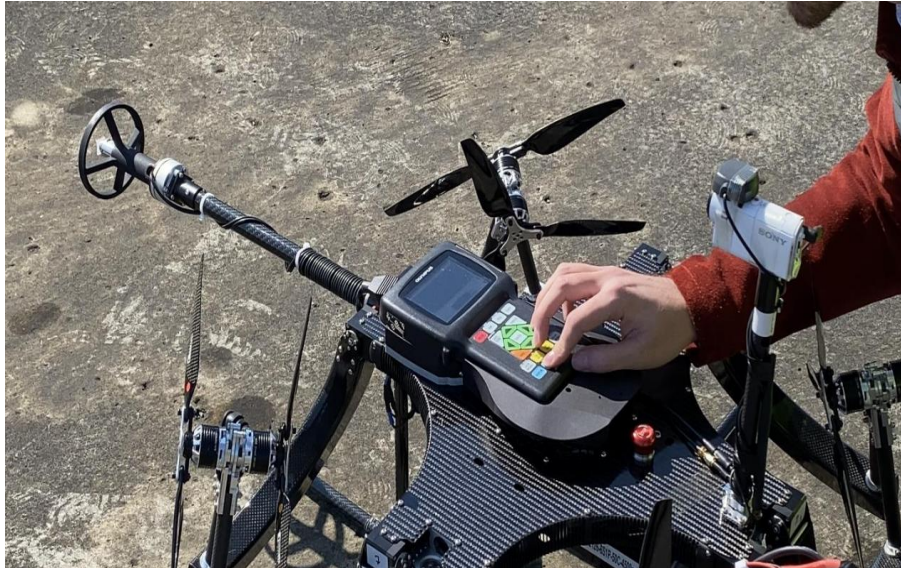
Рисунок 3. – Ультразвуковий безпілотний літальний апарат з обладнанням для визначення товщинометрії магістральних трубопроводів
