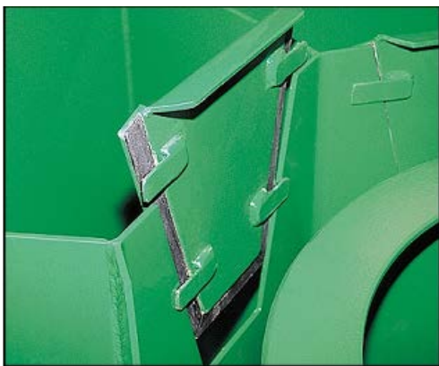
Рисунок 4 – Регулювальні жалюзі механізму подачі для контролю розподілення потоку вібросита Derrick
