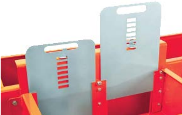
Рисунок 2 – Регулювальні жалюзі механізму подачі для контролю розподілення потоку вібросита MONGOOSEPT
