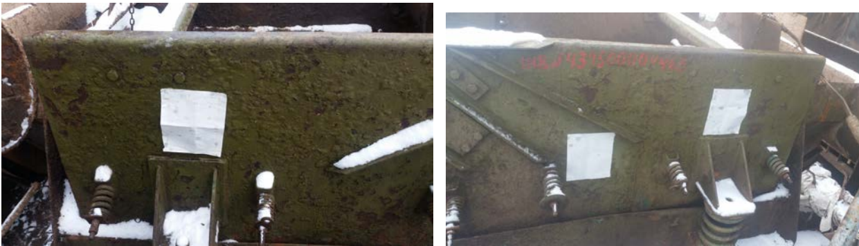
Рисунок 3 – Місця реєстрації амплітуди коливань віброрами: а – задня віброопора, б- середина віброрами та передня пружинна віброопора
