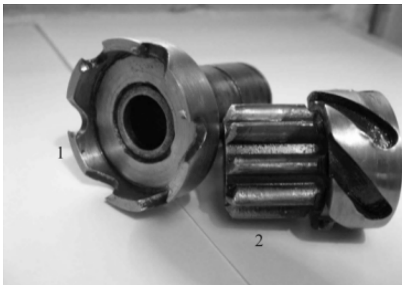
Рисунок 6. - Загальний вигляд ведучої 1 і веденої 2 напівмуфт після перевантажень
