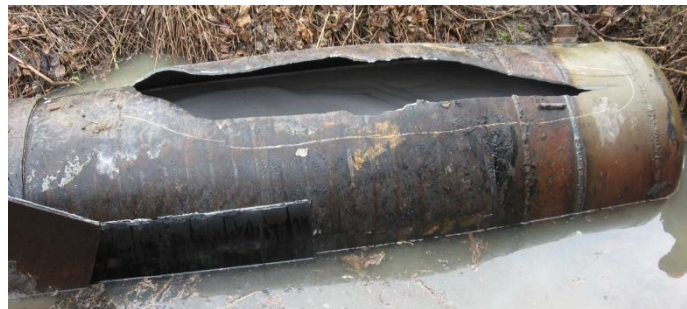
Рисунок 2. – Порушення роботи нафтопроводу ПАТ «Укртранснафта» через значні умови недовантаження, втомні і корозійні руйнування
