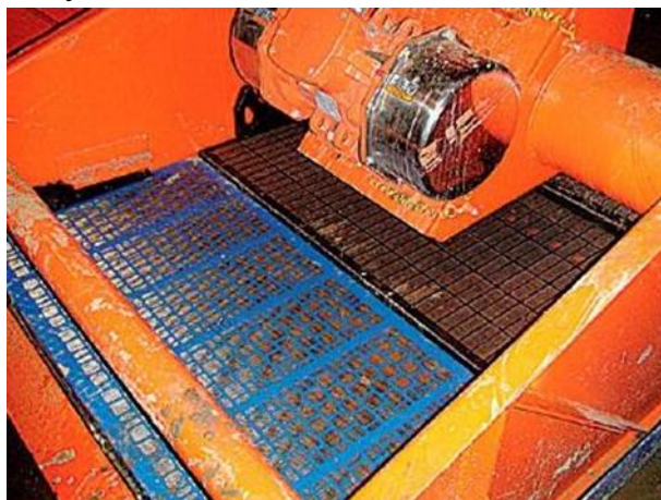
Рисунок 4 – Жорсткі касети на пластиковій (вгорі) та на металевій основі (внизу), встановлені одночасно на віброситі
