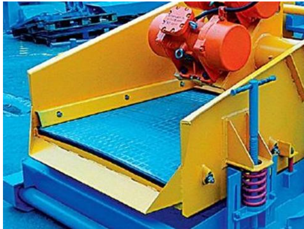
Рисунок 3 – Гнучка натяжна касета, встановлена на віброситі
